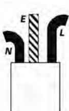
Die Kabel sind die folgt angeschlossen:
